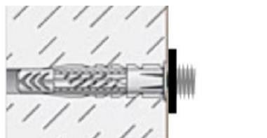
4. **enfoncer la cheville** fournie avec soin, en s'aidant d'un marteau si nécessaire, pour que la collerette de la cheville soit parfaitement aligne avec le mur.
