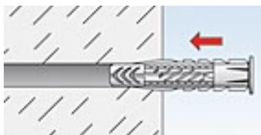
2. **percer un trou de Ø6mm et 45mm de profondeur**, parfaitement perpendiculaire au mur. Utiliser de préférence un foret adapté au matériau de votre mur.
