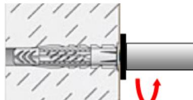
5. **visser la pointe fileté** à l'aide d'un tournevis, d'un embout de visseuse ou d'une clé Torx T10, en prenant garde que la cheville ne pivote pas dans le trou. Laisser la partie non pointue dépasser, c'est sur cette partie que vient se fixer la patère.
